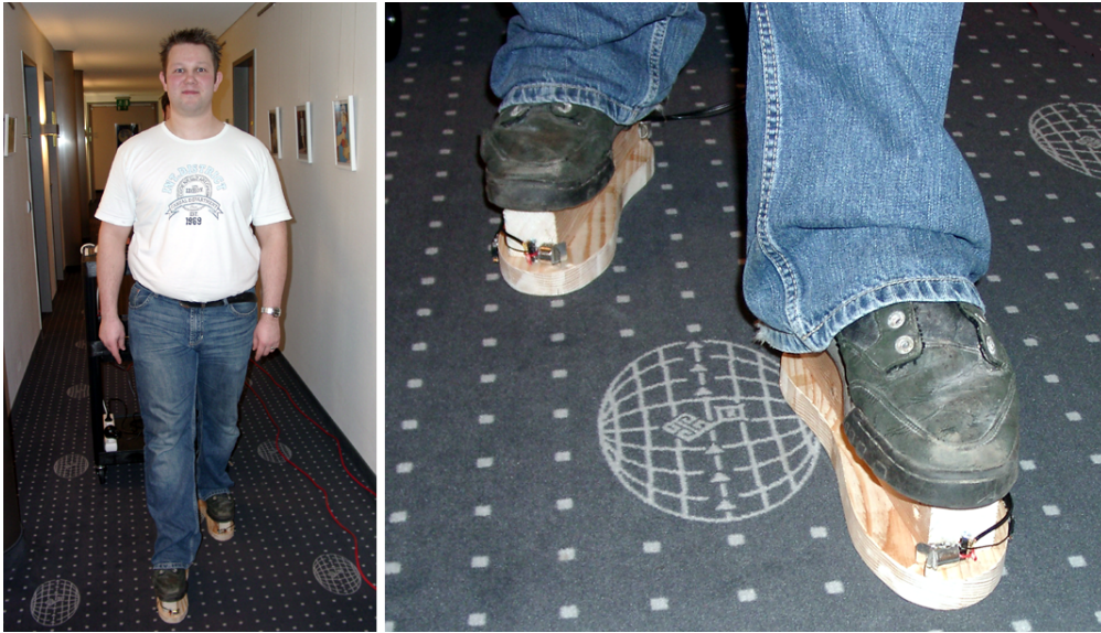
Abbildung 5.6: links: Der Autor bei der Aufnahme von realen Messwerten, rechts die Prototypen mit Druckschaltern
