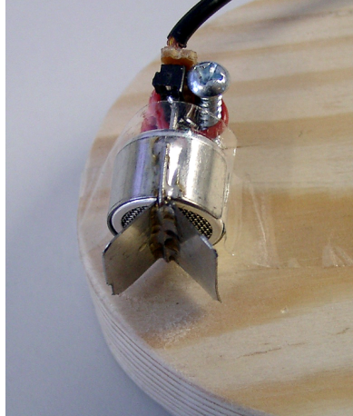
Abbildung 4.17: V-förmiges Blech zur Schallreflektion
