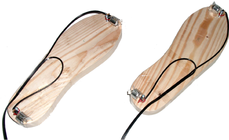
Abbildung 4.14: Ultraschall-Module auf den Holz-Füßen des Prototyps
