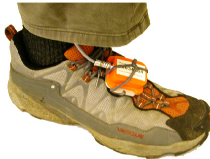
Abbildung 3.5: Xsens MTi IMU am Schuh (Bild: [Beauregard 2007])
