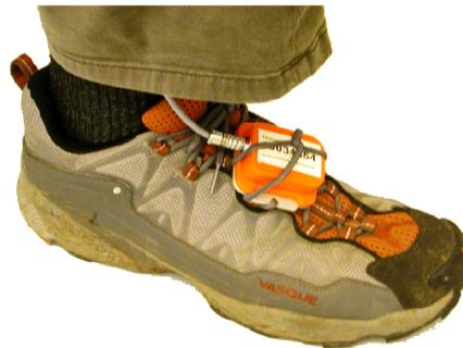
Abbildung 3.5: Xsens MTi IMU am Schuh (Bild: [Beauregard 2007])
