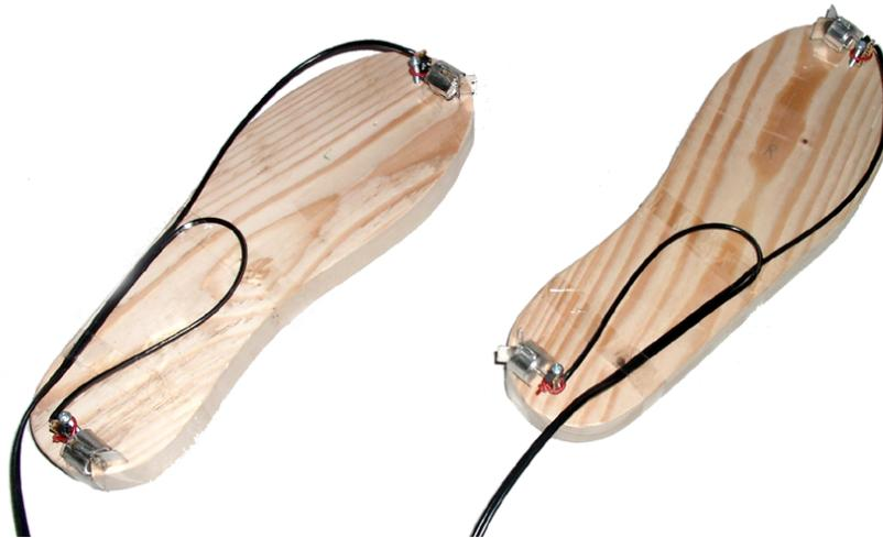
Abbildung 4.14: Ultraschall-Module auf den Holz-Füßen des Prototyps
