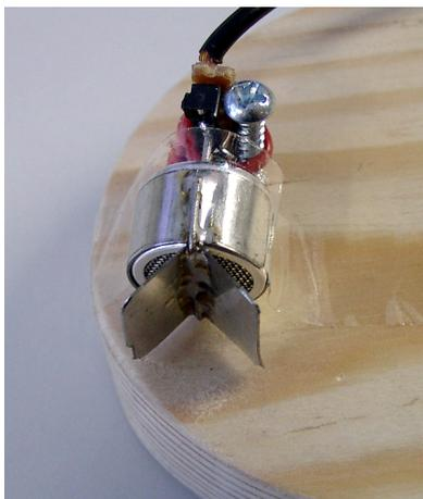
Abbildung 4.17: V-förmiges Blech zur Schallreflektion
